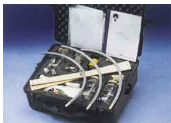
Kit para Ensaio Qualitativo com Vapor de Acetato de Isoamila (óleo de banana)
